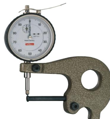
mechanisch, für Rohrwandmessungen
