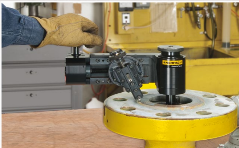
Arbeitseinsatz: Begradigen eines Rohrflansches.
